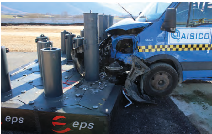
Impatto con veicolo di 3500 kg alle velocità di 48 km/h. Spostamento della barriera a seguito dell'impatto: < 1 mt. Zero penetrazione del mezzo a seguito dell'impatto. Crash test del 25/1/18 eseguito presso Aisico srl.
